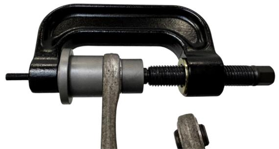
....mit einem vorhandenen C-Bügel K 65-21. Hier kann auch der Schlagschrauber als Antrieb verwendet werden.
