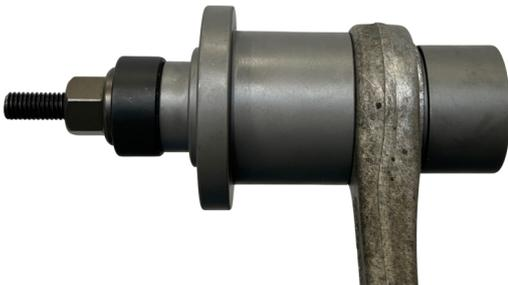
....mit der mitgelieferten Spindel Mutter und dem Drucklager.
