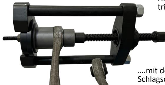
....mit dem Pressrahmen K 65 und der Schlagschrauberspindel K 300-36.
